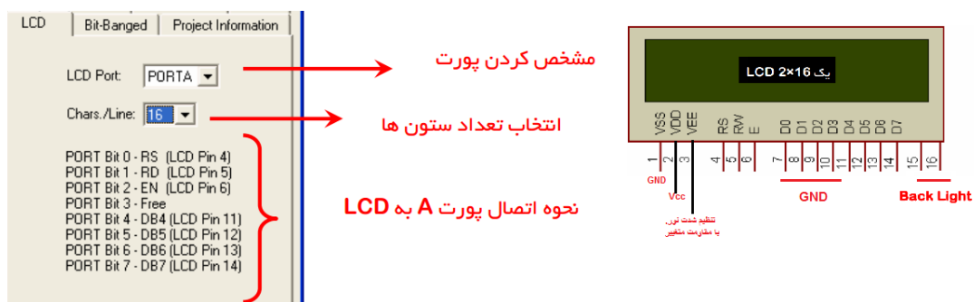
شکل ۸: سربرگ LCD و نحوه اتصال LCD
